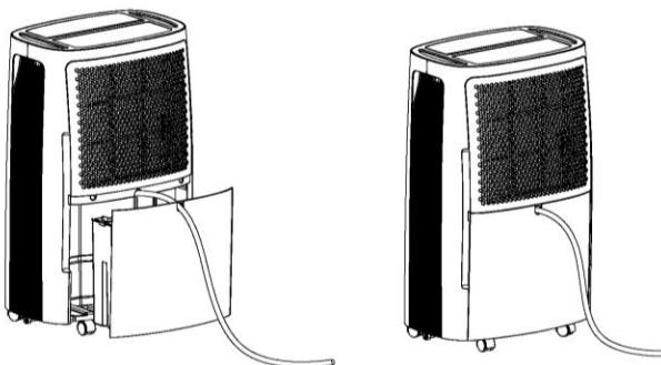
**Nota:** O tubo de água não pode ser muito longo (geralmente 0,6 m ou 1 m), a altura não pode ultrapassar a altura da boca de drenagem, ou haverá vazamento de água.
