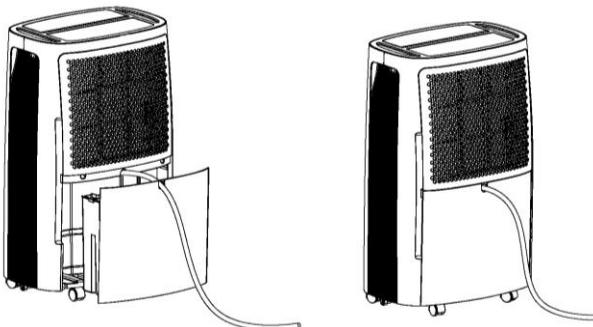
**Remarque : Le tuyau d'eau ne peut pas être trop long (généralement 0,6 m ou 1 m), la hauteur ne peut pas dépasser la hauteur de la bouche de drainage, ou il y aura des fuites d'eau.**
