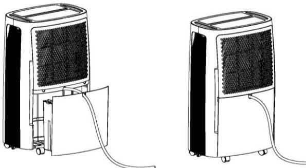
**Nota:** La tubería de agua no puede ser demasiado larga (por lo general 0.6m o 1m), la altura no puede superar la altura de la boca de drenaje, o habrá fugas de agua.
