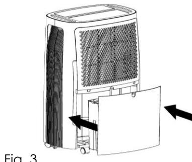
3. Uma vez vazio volte a colocá-lo no aparelho. Ao colocar o depósito, pressione-o firmemente e empurre com as duas mãos. Se o mesmo não estiver posicionado corretamente, o sensor de “**tanque cheio**” será ativado, e o desumidificador deixa de funcionar. (Fig.3)
